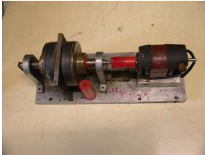
Figura 3: uno dei primi prototipi da noi realizzati sulla base della macchina di de Palma, costituita da due ruote omopolari in serie
